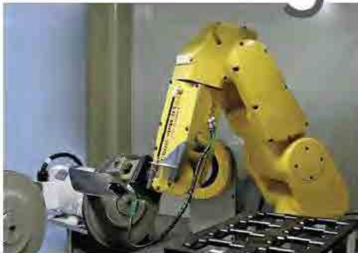
Voilà un système robotisé imaginé, conçu et programmé par AV&R. Il profite les bords d'attaque et de l'insert d'aube de moteurs d'avion. Un produit à succès, quatorze sont en usage chez les motoristes.
