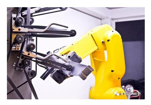
近日,AV&R 航空航天公司推出了用于航空发动机叶片抛光的新型机器人解决方案,能够提高叶片的气动效率。该解决方案已经经过三年的beta测试,可以根据客户的公差和表面光洁度要求,自动抛光航空发动机叶片的叶形、凸台和圆角半径。
